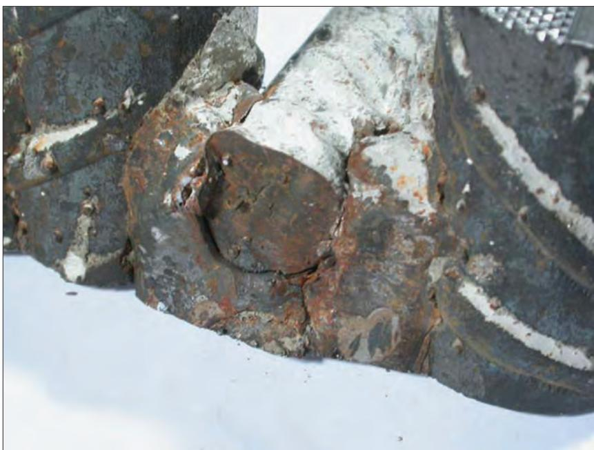
Figura 6 - Incollatura di un giunto evidenziata dallo sfilamento del tondo di armatura durante la prova di trazione
