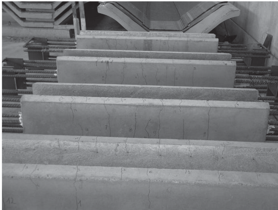
Figura 7 – Coppie di provini dopo i test. Si nota la variabilità del numero di fessure.
