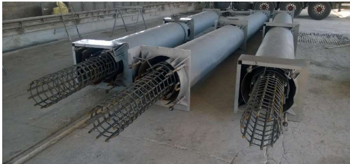
Pilastri Tubolari con tirafondi e gabbia d'attesa per concio superiore
