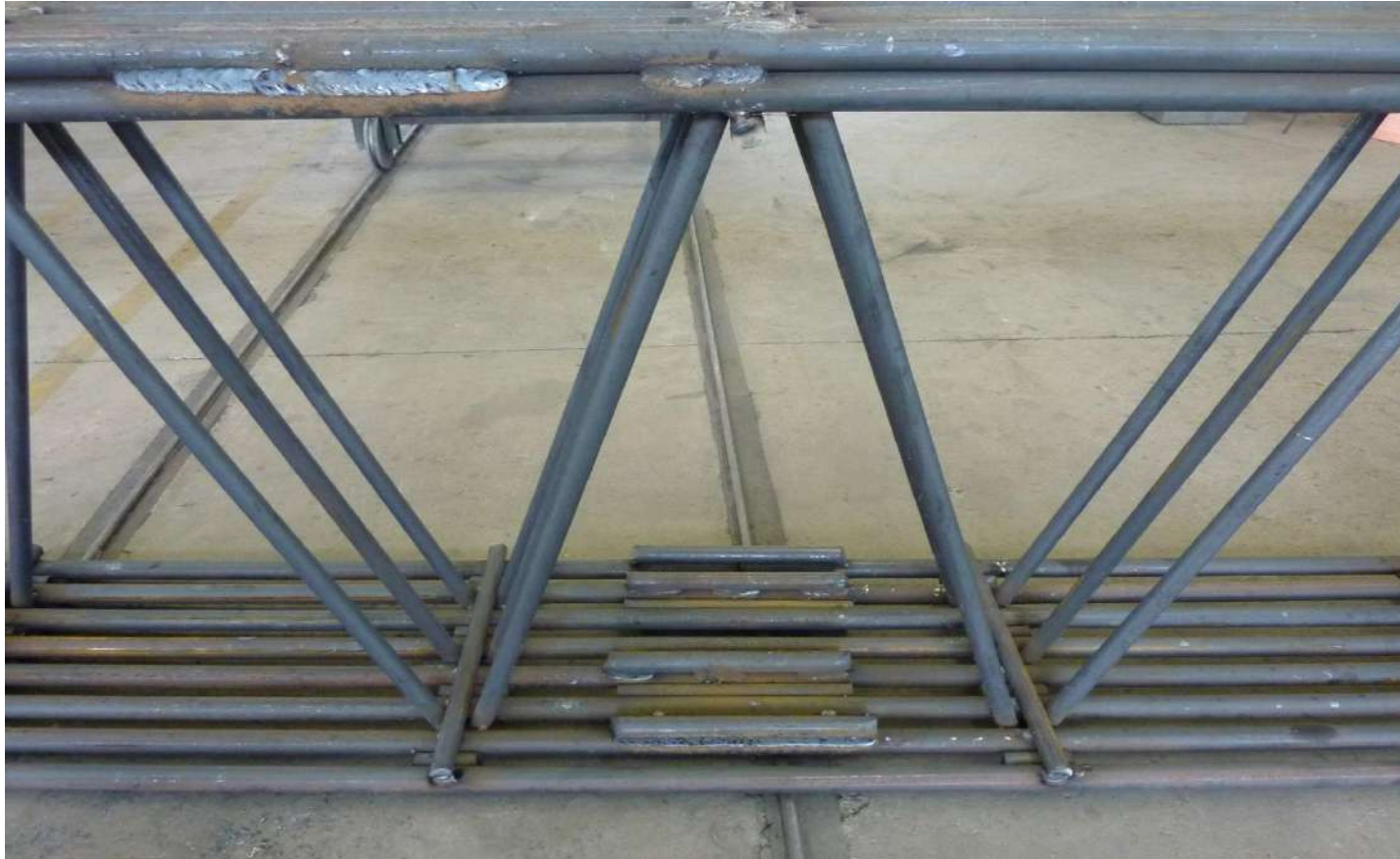
Trave PREM di Categoria "a" – Mista Acciaio Calcestruzzo – Certificata da STC su L.G. del CSLP (Solo acciaio liscio - connessione solo meccanica col cls - Taglio solo sul traliccio: No Morsh)
