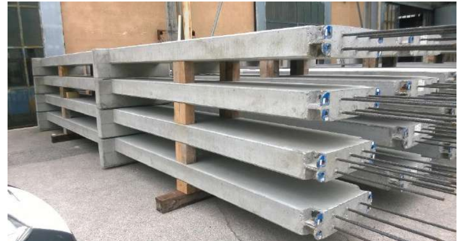
Pilastri setti con scarpe e ferri di ripresa per guaine
