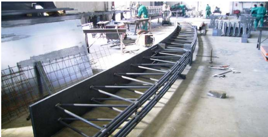
Nuovo Sovrappasso per Centro Sportivo (BL) – Conci di Travi PREM a1 con spondine in acciaio, zincati e imbullonati
